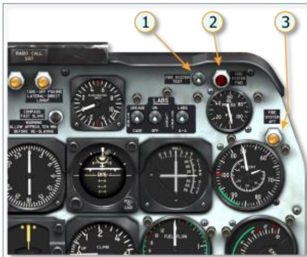
Abbildung 5-10: Anzeigesystem für Triebwerkbrand
