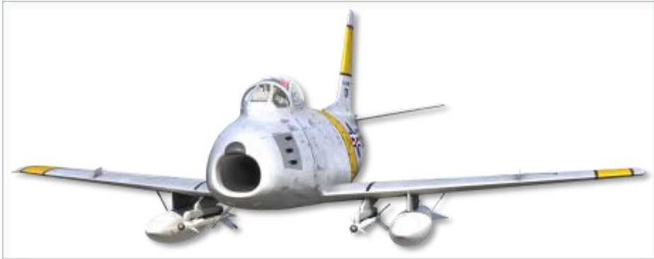
Abbildung 6-17: Flugzeug mit GAR-8 Luft-Luft-Raketen und Zusatztanks Für Spezifikationen der GAR-8 Rakete, siehe Tabelle 6-4
