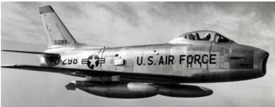
Abbildung 1-6: F-86 Sabre mit externen Treibstofftanks
