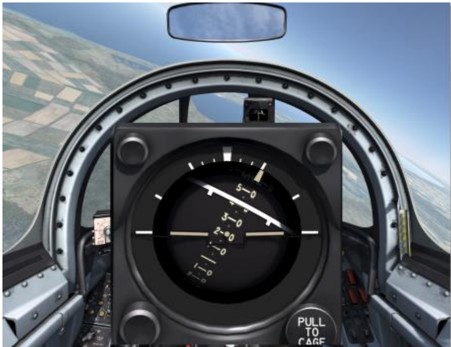
Abbildung 4-9: Anzeige des Künstlichen Horizonts bei einem 20°-Sinkflug und einer 30°-Linkskurve
