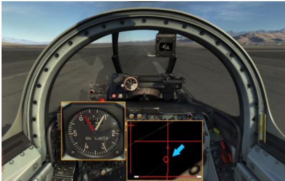
Abbildung 8-1: Position des Steuerknüppels bei einer Rollgeschwindigkeit von 20 - 30 Knoten geringer als die Abhebegeschwindigkeit des Bugrades
