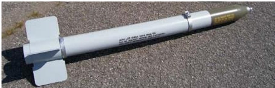
Abbildung 1-18: Ungelenkte 127-mm-HVAR (Hochgeschwindigkeits-Flugzeugrakete)
