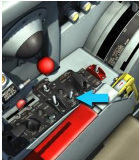
Abbildung 5-2: Die Lage des Seiteruder-Trimmschalter
