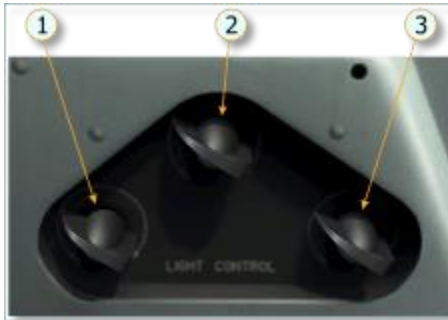
Abbildung 5-16: Helligkeitsregler-Bedienfeld für Cockpit-Beleuchtung
