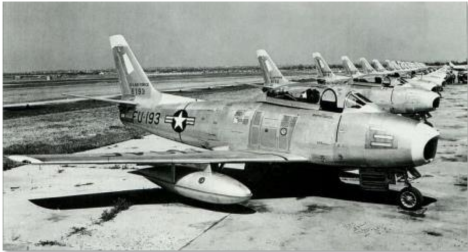
Abbildung 1-10: F-86A-5 mit abgedeckten Maschinengewehröffnungen und externen Treibstofftanks
