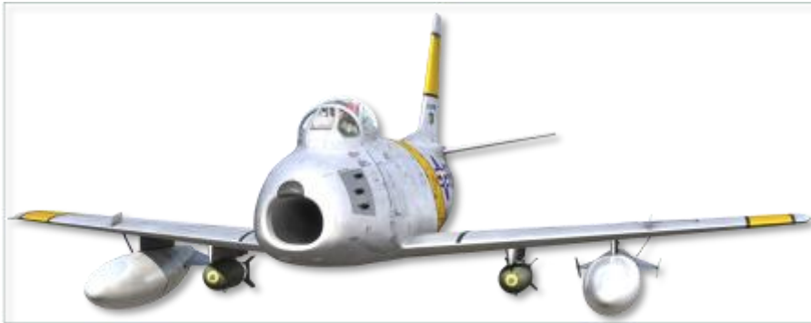
Abbildung 6-8: Bomben und Abwurf-tanks sind installiert
