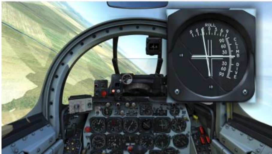
Abbildung 11-2: LABS-Rollanzeige zeigt 35° rollen nach links an
