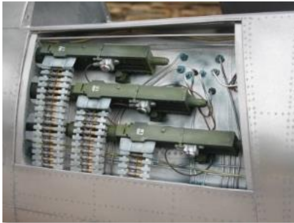
Abbildung 6-4: Linke Seite einer F-86 mit drei Maschinengewehren AN/M3
