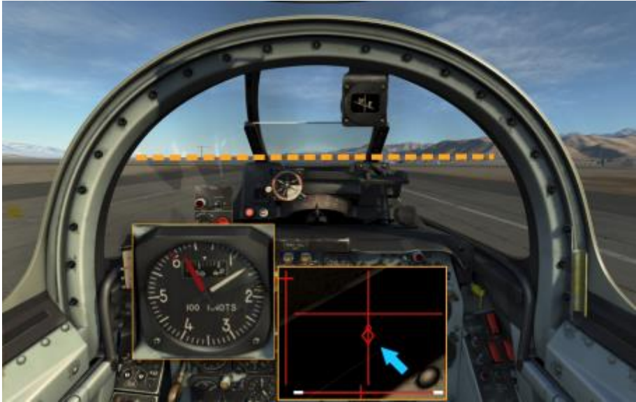
Abbildung 8-2: Position des Steuerknüppels und der Cockpithaube kurz vor dem Abheben des Flugzeugs von der Startbahn
